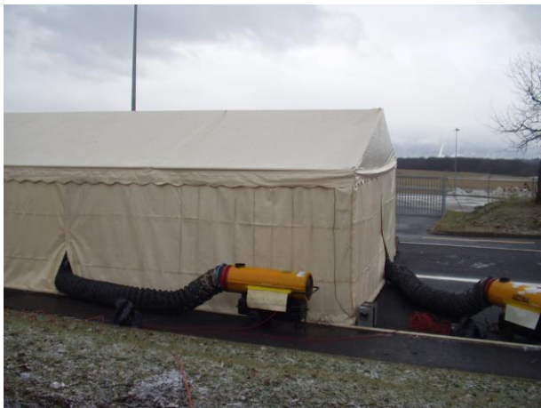
Gaine souple pour amenée d'air chaud
