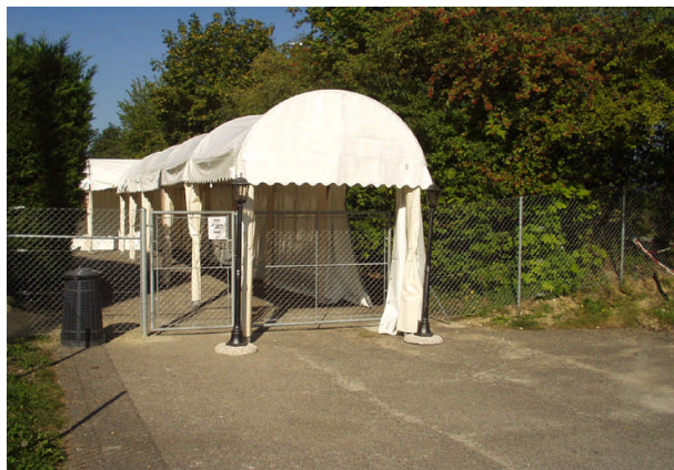
Passage couvert, liaison, montage en série, avec structures cintrées, blanc. Eléments de 2.00 x 3.00 m. Hauteur de passage mini 2.20 m
