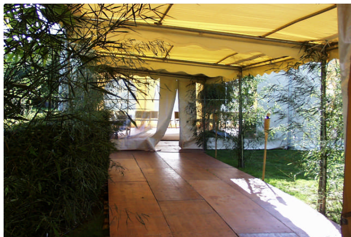
Passage couvert, liaison, montage en série, avec structures toit 1 pan, blanc champagne. Éléments de 2.50 x 3.00 m. Hauteur de passage maxi 2.10 m
